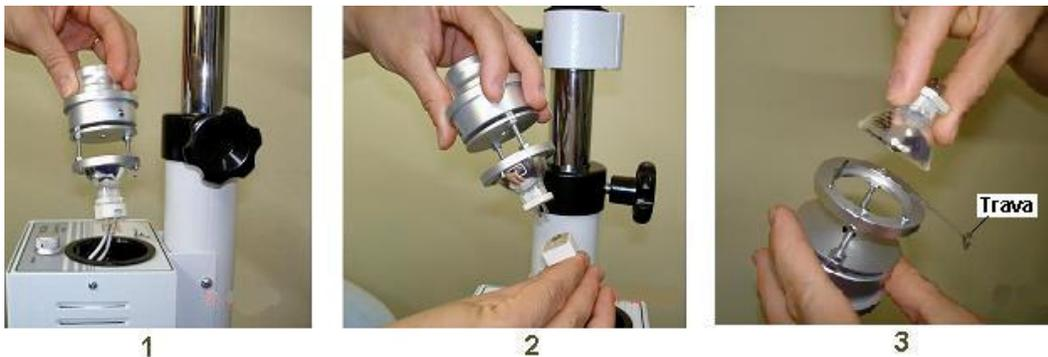
Figura 13 – Troca da lâmpada do modelo com fibra óptica
