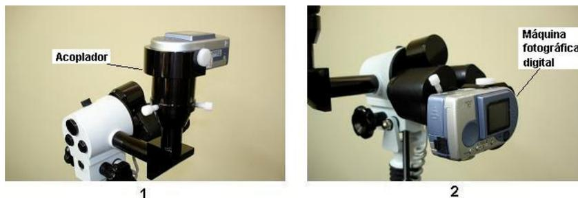
Figura 11 – Máquina fotográfica digital e Acoplador
